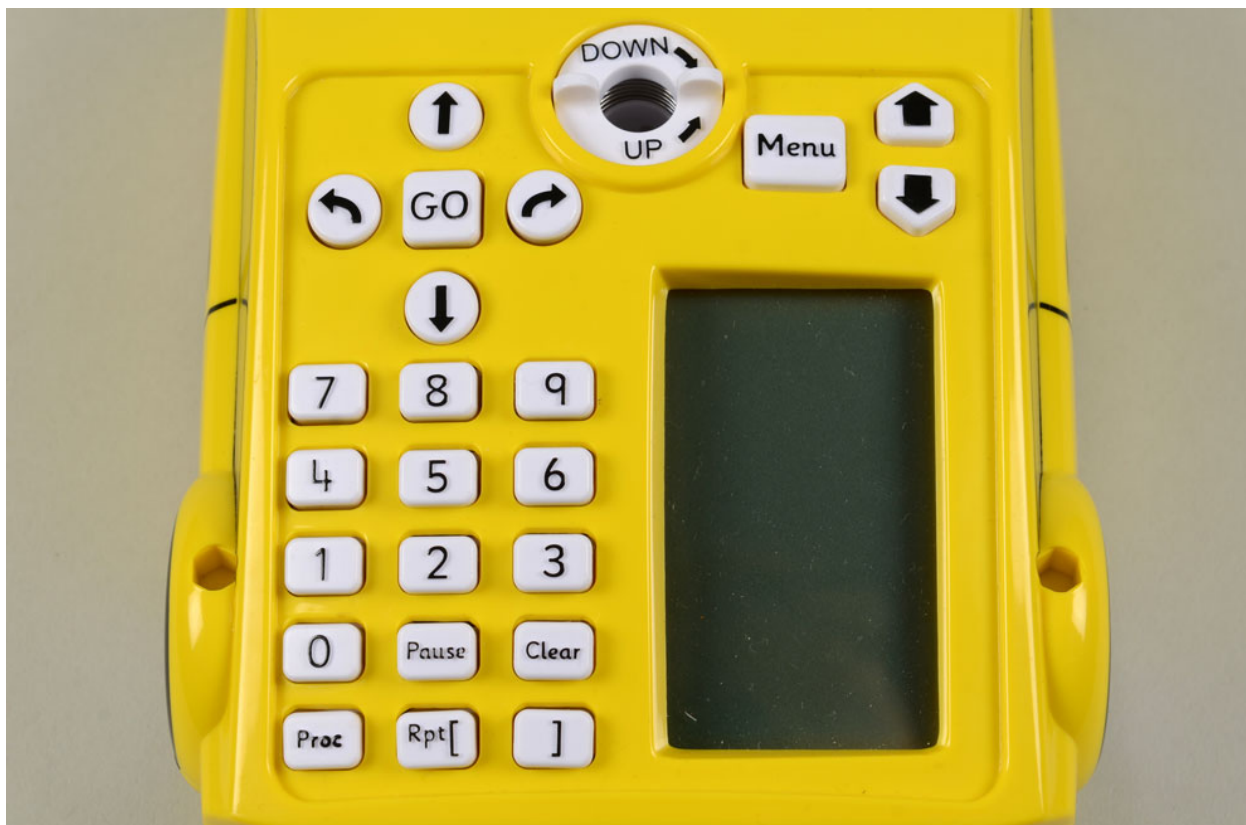
Abbildung 1: Programmiert wird der Pro-Bot über die abgebildeten Tasten. Es ist kein Computer nötig.
